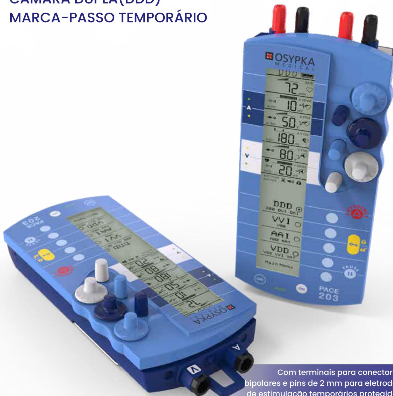
Com terminais para conectores bipolares e pins de 2 mm para eletrodos de estimulação temporários protegidos ao toque (encapados)
